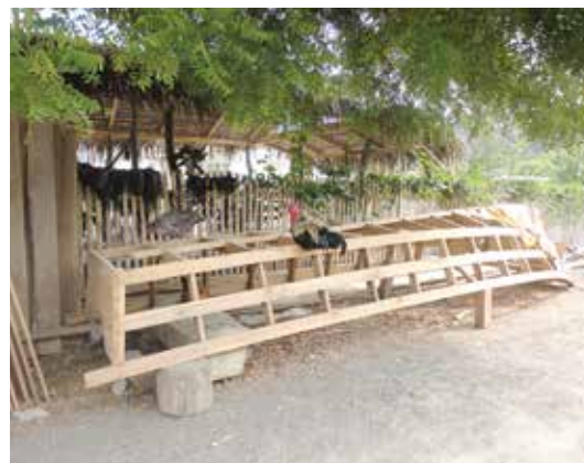
▲ Esqueleto de embarcación elaborada por los armadores de San Clemente, Japotó
